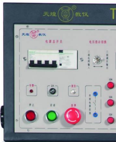
图2 电源控制屏2（调压器）
