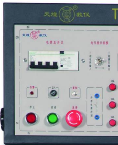
图2 电源控制屏2（调压器）
