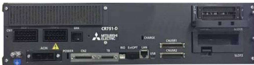
图 2 机器人控制器接口面板
