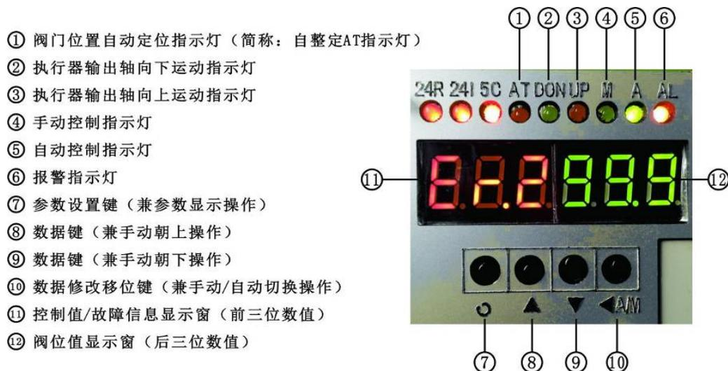
图3 电动调节阀操作面板
