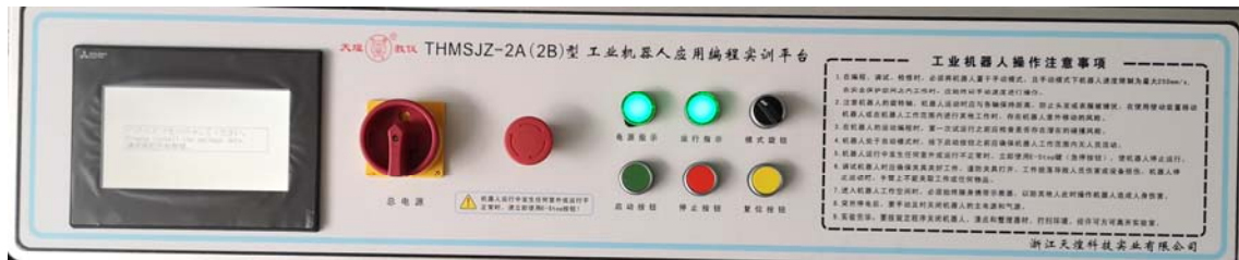
图12实训台控制面板
