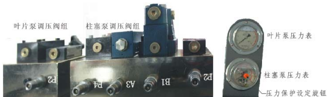
图4 工业双泵液压站油口钢印分布图
