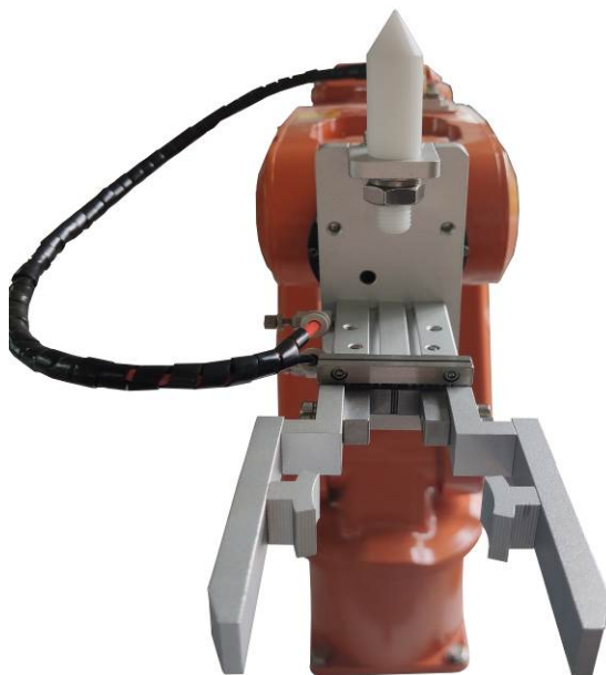
图2 安装机器人手爪
