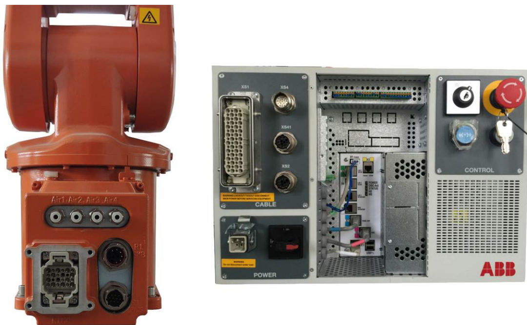
图3 机器人本体接口和控制器接口
