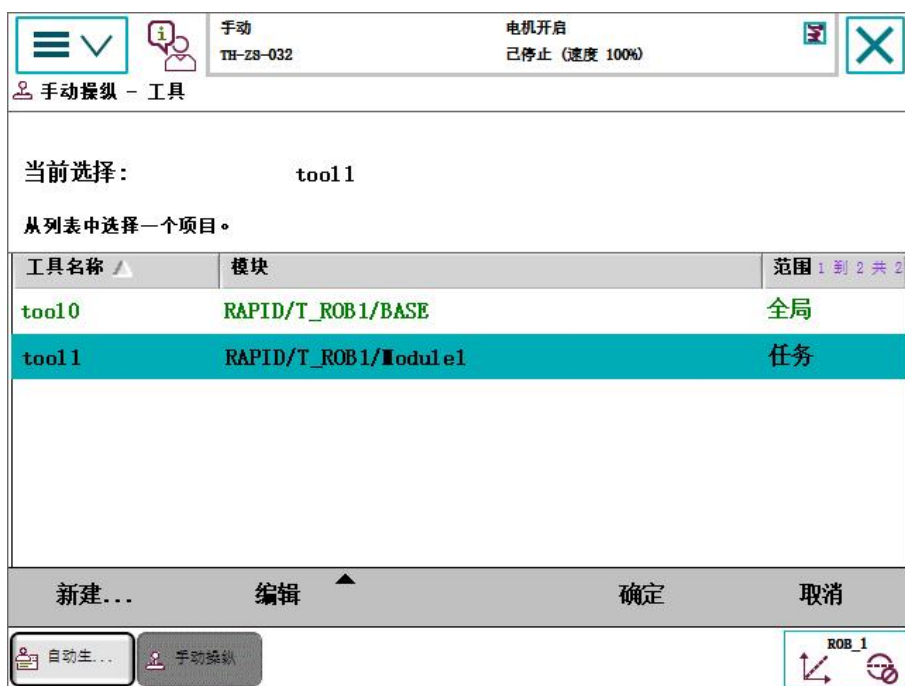
图18 工具坐标标定完成
