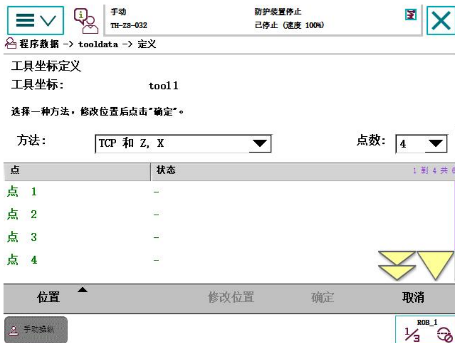
图11 工具坐标定义
