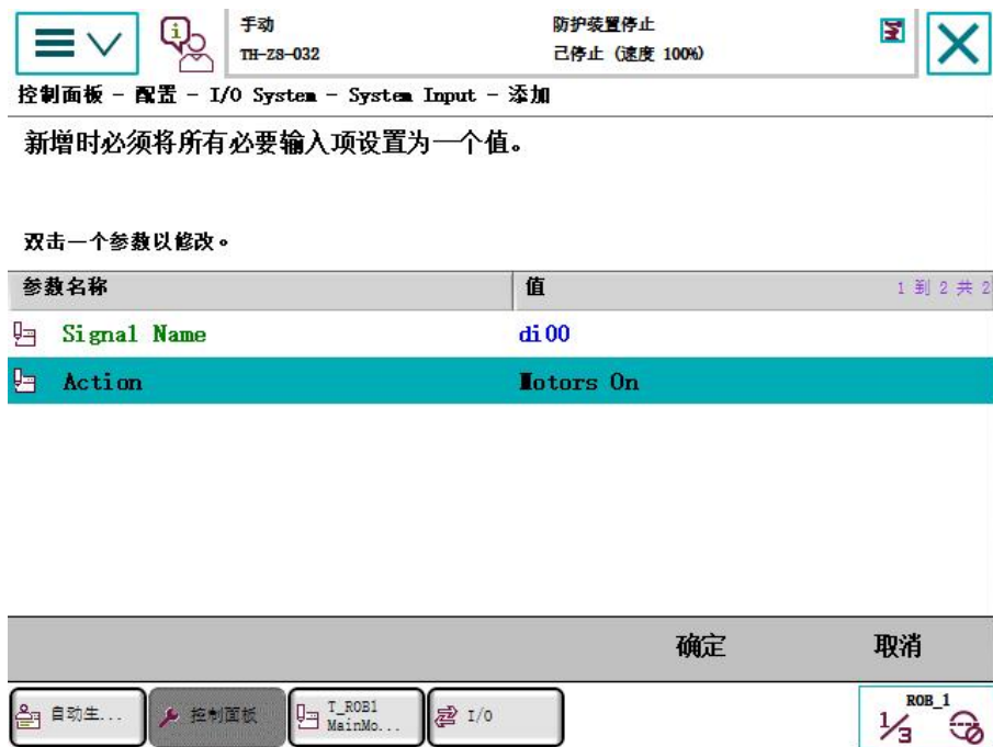
图8 System Input设置界面
