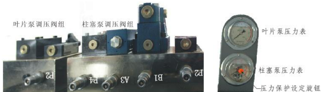
图4 工业双泵液压站油口钢印分布图
