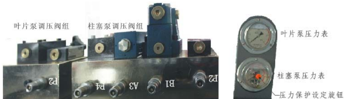
图4 工业双泵液压站油口钢印分布图
