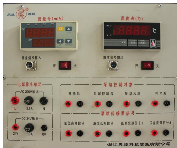
图2 平台电气控制面板2
