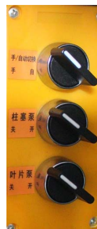
图3 泵站控制电控盒
