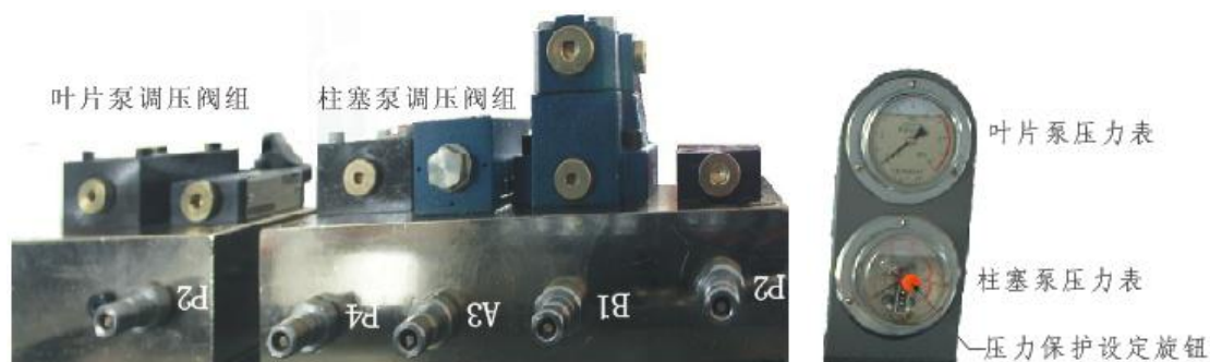
图4 工业双泵液压站油口钢印分布图
