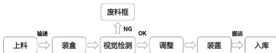
图 1 工件装配生产工艺流程
