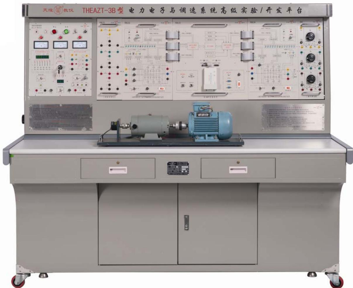
图 2 THEAZT-3B 型 电力电子与调速系统高级实验/开发平台
