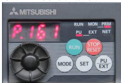
图 18 频率设定/键盘锁定选择设置参数
