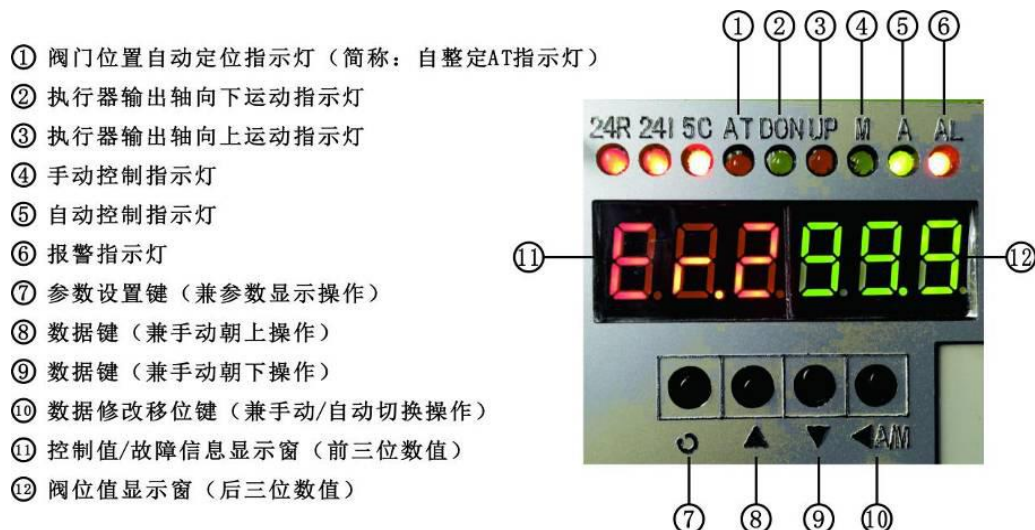
图3 电动调节阀操作面板
