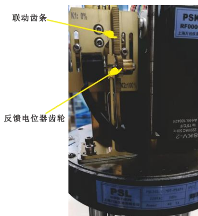
图6 反馈电位器齿轮及联动齿条位置说明
