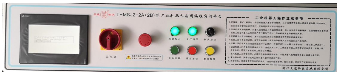
图12实训台控制面板
