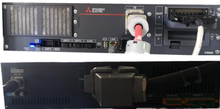
图1 机器人控制器接口面板
