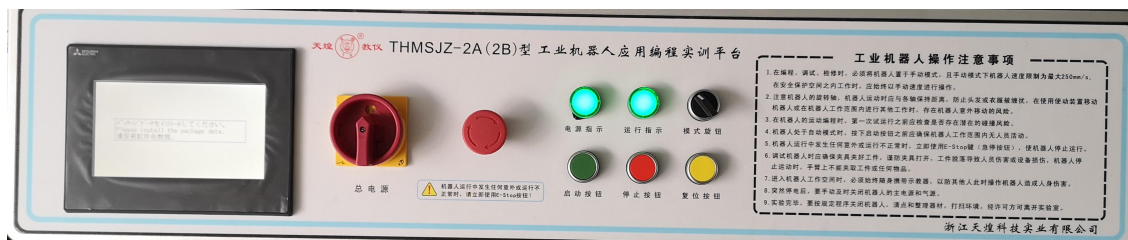
图12实训台控制面板
