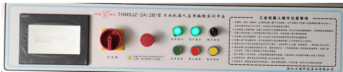
图 2 平台电气控制面板 1
