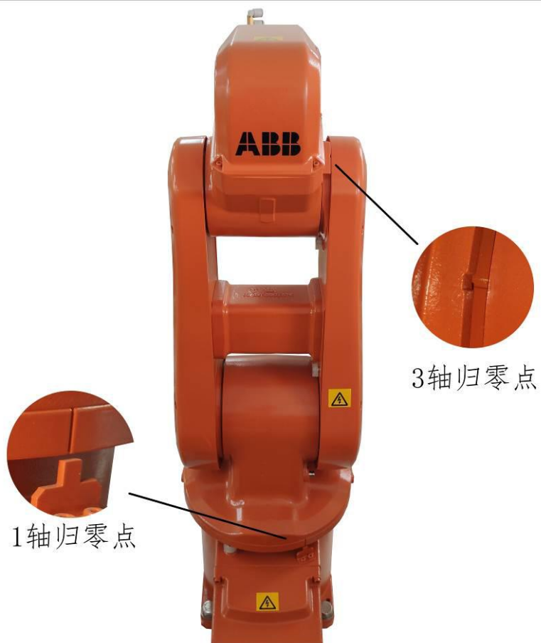
图4 机器人各关节轴归零点位置
